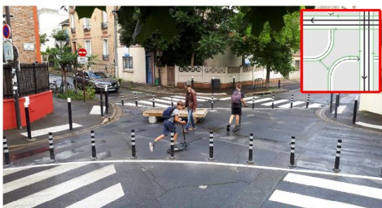
Le « filtre modal », une réalisation mise en œuvre à Montreuil
